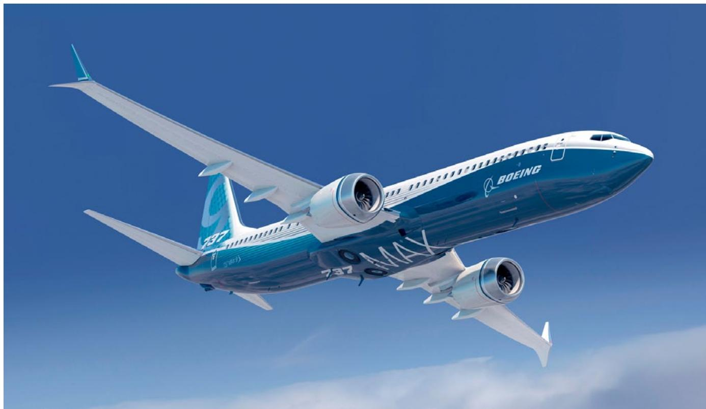
ми самолеты 737NG, которые оборудованы элементами Aviation Partners Inc (в то же время API представила подобную конструкцию законцовок в октябре прошлого года). Однако в будущем производитель может вернуться к вопросу модернизации остальных моделей семейства 737 такими винглетами.
