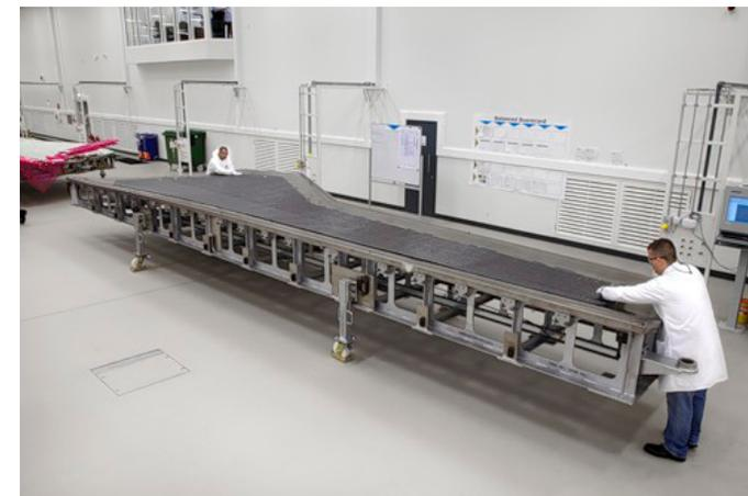
целостность. В ближайшее время производитель планирует установить на нем носовую часть, перегородки, пол, лобовое остекление и двери. После этого он поступит на линию окончательной сборки вместе с хвостовой частью.
