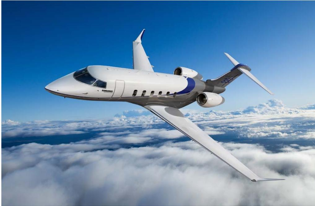
Судя по всему, в новом самолете производитель оставил планер 300-й модели почти без изменений, установив новые двигатели, авионику и интерьер пассажирского салона. Такой подход модернизации производственной линейки компания уже опробовала на самом младшем представителе семейства Learjet – 40/45, превратив их в Learjet 70/75.
