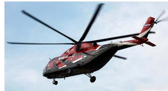
входящем в холдинг Казанском вертолетном заводе. Вертолет типовой конструкции ОП-4 будет отличаться от прототипа ОП-3 наличием ударостойкой топливной системы французской компании Aerazur и увеличенными проемами иллюминаторов. Начало серийного производства Ми-38 запланировано на 2015 год.
