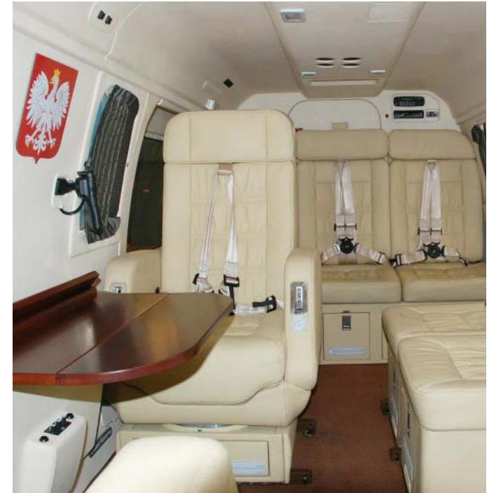
VIP-пассажиров. Он также оборудован аудиосистемой, которая интегрирована в систему вертолета. Это позволяет пассажирам общаться между собой, а с помощью мобильной телефонной системы они могут связаться с внешними абонентами. Салон оборудован дополнительной звукоизоляцией, которая обеспечивает низкий уровень шума.
