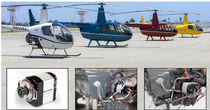
Электронная система зажигания заменяет левое пусковое магнето. Оставшееся правое магнето обеспечивает дополнительное зажигание и устраняет необходимость в резервном источнике питания. Электронная система зажигания также отличается высоким искровым разрядом, что обеспечивает легкий запуск двигателя и устраняет трение между частями, увеличивая надежность работы.
