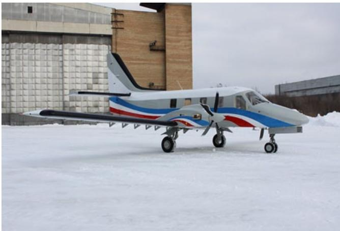
ЦМКБ «Прогресс». Во время первого полета на самолете были установлены двигатели M601. H80 является его улучшенной модификацией, которая позволит эксплуатировать самолет в более жарких условиях и на больших высотах. Сейчас новый двигатель проходит летные испытания и уже выбран для ремоторизации чешских самолетов местных авиалиний L-410.
