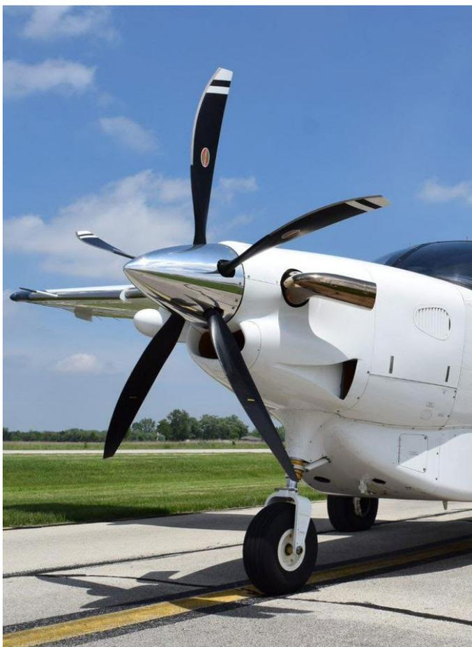
Новая конфигурация винта будет на 6,3 дБ тише и на 13 фунтов легче, чем нынешняя версия с четырехлопастным металлическим винтом, при этом уменьшая разбег самолета на 6% при максимальной взлетной массе.
