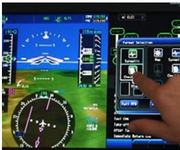
Это обновление добавит новые возможности к существующим системам «стеклянных» кабин экипажа, разработанных компанией. К новшествам Rockwell Collins в первую очередь относит простоту вывода на экран служебной информации системы управления полетом. Теперь это можно сделать просто проведя пальцем по экрану.
