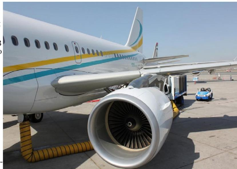
Двигатели, которые будут установлены на новый самолет ACJ321, будут выполнены в конфигурации Performance Improvement Package (PIP). Двигатель 5B в конфигурации PIP прошел обширные наземные испытания, а летные испытания A320, оснащенного этим двигателем, продолжались более 26 часов. Двигатель, который является новой конфигурацией CFM56-5B, поступил в эксплуатацию в начале ноября 2011 г.
